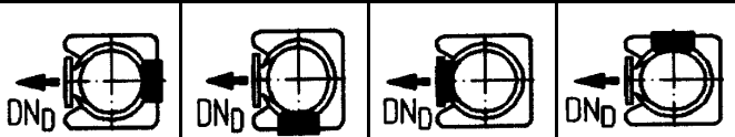
Motorklemmenkastenrichtungen (Ansicht A) Arrangements de la boîte à bornes du moteur (vue A) Arrangements of motor terminal box (view A)
